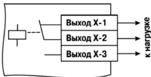
Рис. Б.1. Схема подключения нагрузки к ВУ типа Р
