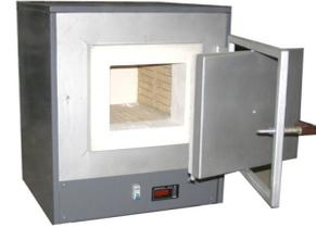
Печи оборудованы автоматическим микропроцессорным цифровым (А) терморегулятором позиционного типа, термопарой ТХА, высококачественной теплоизоляцией, **муфель - керамический**.
